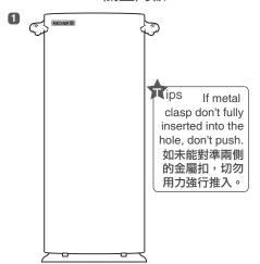
Upper metal clasp holes align insert body. 把上方兩側金屬扣對準插入機身扣孔內。
