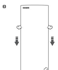
Push down cover gently to release the lower left button & cover. If not, press the left button. 把門蓋輕輕往下推,即可鬆開左下方金屬扣及取出門蓋。如未能則請按一下左方的金屬片按鈕。
